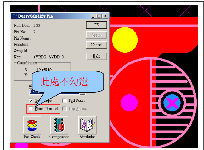
圖(二)關 Dip 零件的 Plan Thermal 方法
